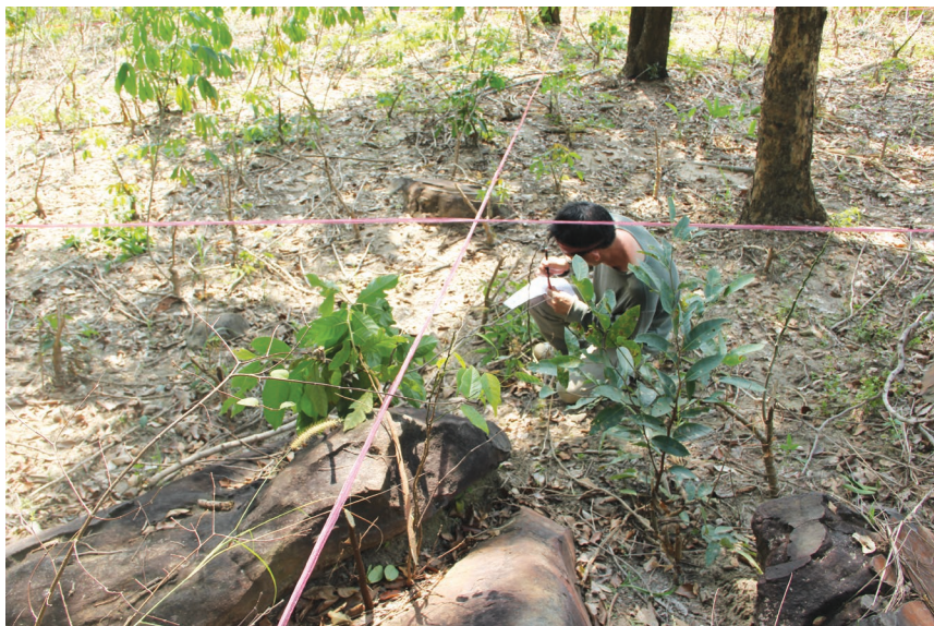
ภาพที่ 15 การใช้ GPS วัดระดับความสูงของพื้นที่ของแต่ละจุดในแปลงตัวอย่าง บริเวณที่โล่งแจ้งจะรับสัญญาณดาวเทียมได้ดีกว่าในพื้นที่ป่าทึบ
