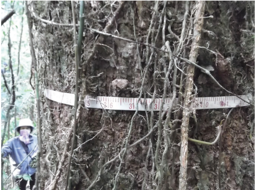
ภาพที่ 10 ในกรณีต้นไม้มีรากไทรหรือเถาวัลย์ปกคลุม การวัด DBH ที่ต้องสอดเทปให้แนบกับลำต้นของต้นไม้
