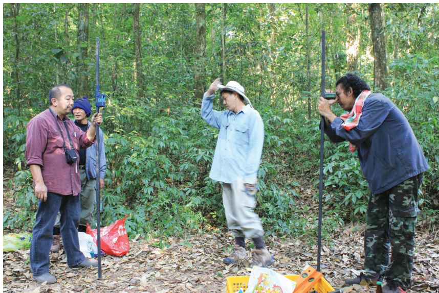
ภาพที่ 16 การทดสอบ Vertex ระหว่างเป้าและตัวยิงให้ได้ศูนย์องศาก่อนนำไปใช้ถ่ายระดับในพื้นที่
